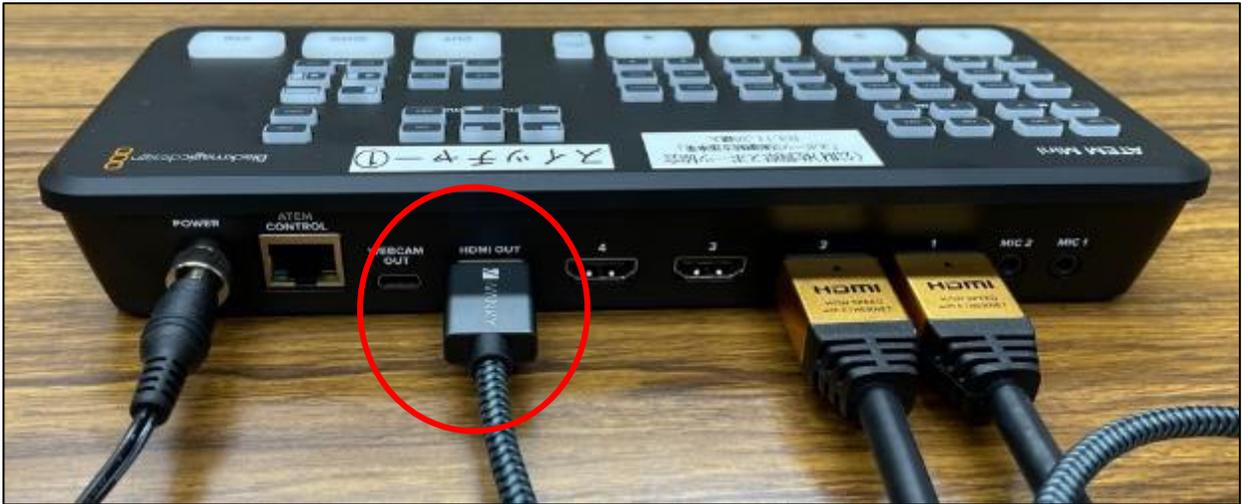
4. グレーのケーブルの反対側をモニターの【HDMI IN】に接続する
